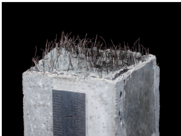
Um die Duktilität des Materials zu steigern, wird UHFB mit Stahl- oder Kunststofffasern bewehrt
