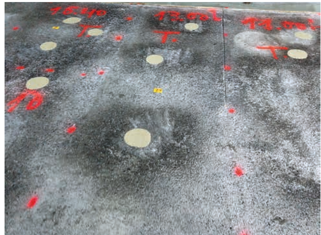
Versuchsfelder mit unterschiedlicher Oberflächenbearbeitung
