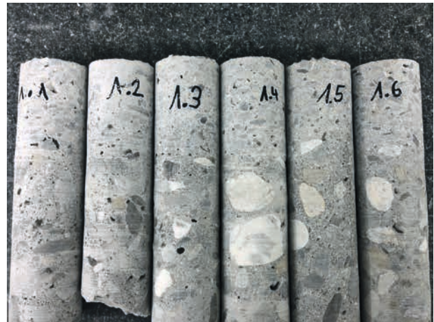
Bohrkerne Ø 50mm des 1. Probeinbaus
