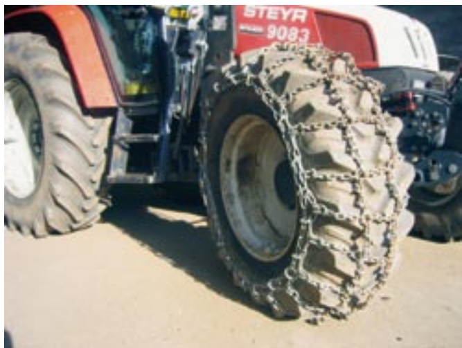
Bild 1: Mechanische Beanspruchung durch Schneeketten
