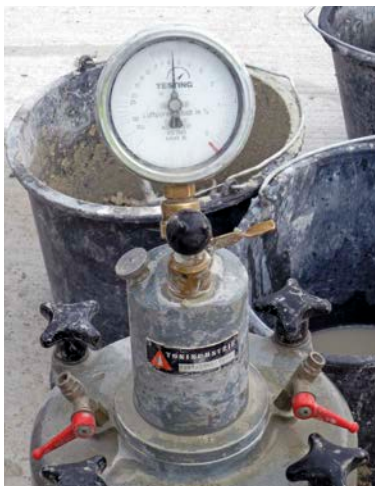
Bild 5: Messung des Luftporengehalts
