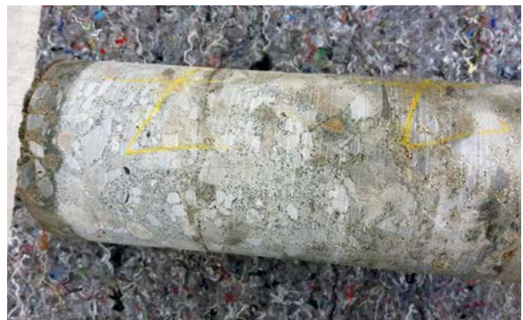
Bild 4: Bohrkern aus der Versuchsstrecke für den zweilagigen Einbau von Walzbeton
