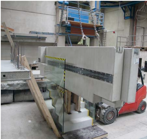
Bild 3: Belastungstest im Fertigteilwerk
