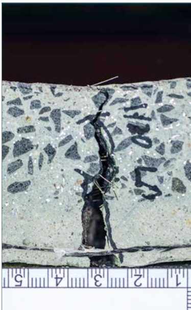
Bild 8: Sandwichquerschnitt (d = 4 cm) nach Prüfung
