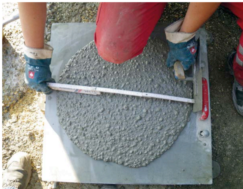
Bild 3: Messung des Ausbreitmaßes auf der Baustelle
