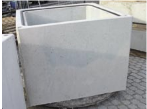
Bild 8: Blaufärbung eines Schachtbauteils mit Hochofenzement nach wenigen Tagen auf dem Freilager
