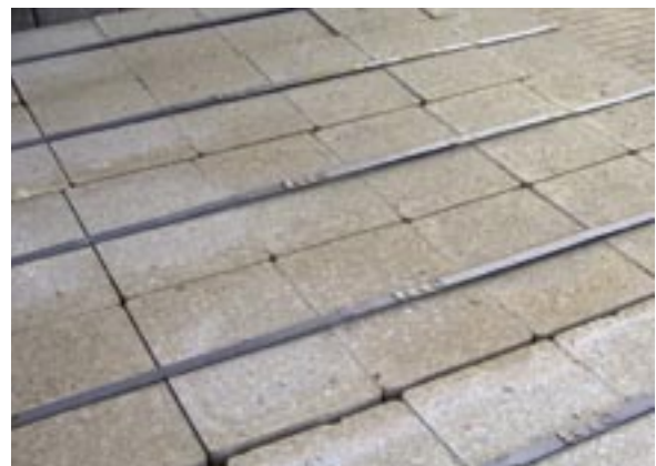
Bild 4: Bereits auf dem Lagerplatz entstandene Gelb-/Braunverfärbungen
