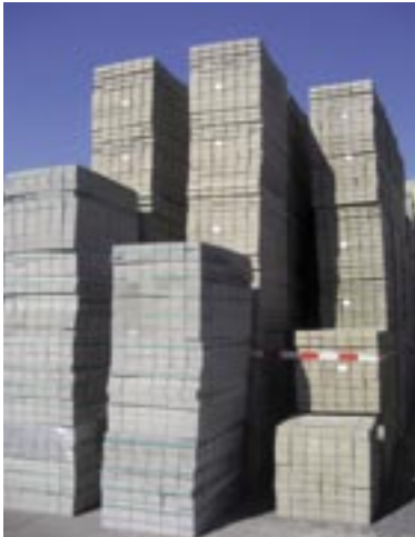
Bild 5: Gelb-/braunverfärbte Pflastersteine mit Basalt hinter Pflastersteinen mit üblicher Grautönung ohne Basalt
