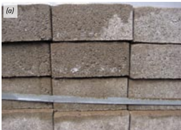
Bild 1: Kalkausblühungen nach frühzeitiger Auslagerung bei nasskalter Witterung; Ansicht Seite (a) bzw. Oberfläche (b)
