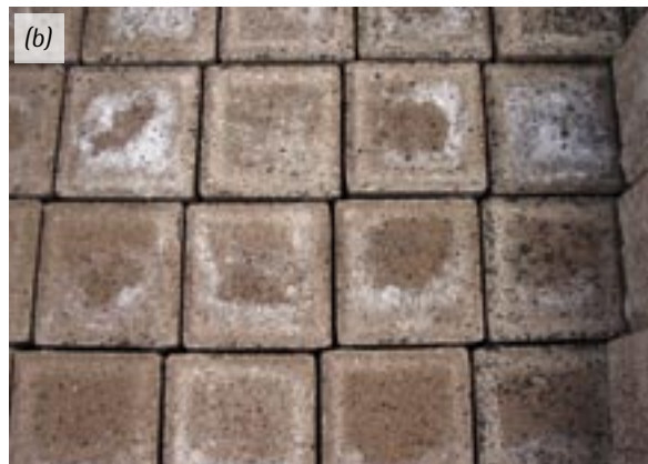
Bild 1: Kalkausblühungen nach frühzeitiger Auslagerung bei nasskalter Witterung; Ansicht Seite (a) bzw. Oberfläche (b)
