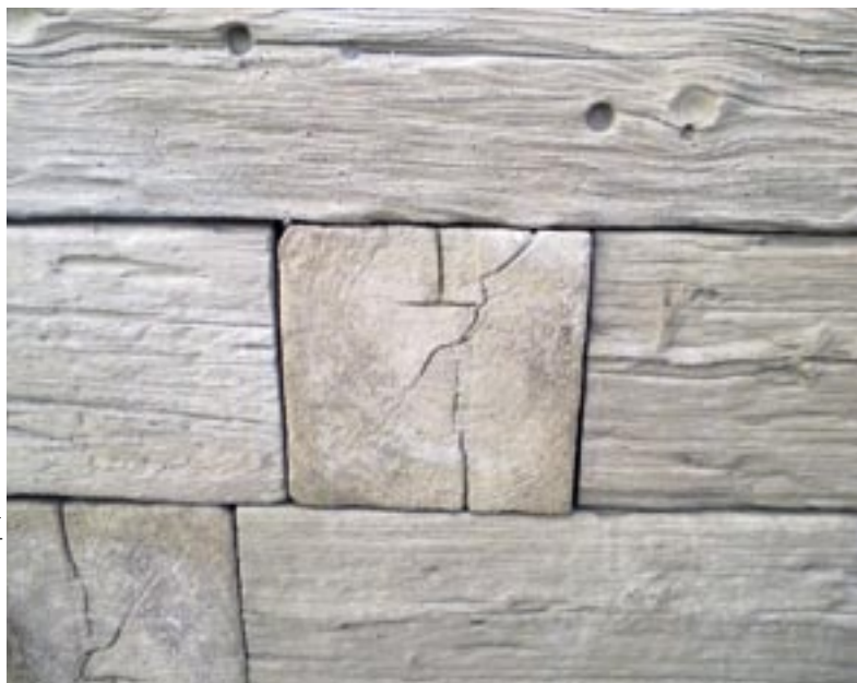
Bild 1: Im WetCast-Verfahren hergestellte Betonwaren, zum Verwechseln ähnlich
