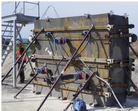
Bild 9: Probetonage der Innenschale
