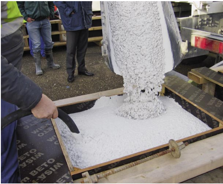
Bild 6: Herstellung der Probelöcke für den weißen Beton
