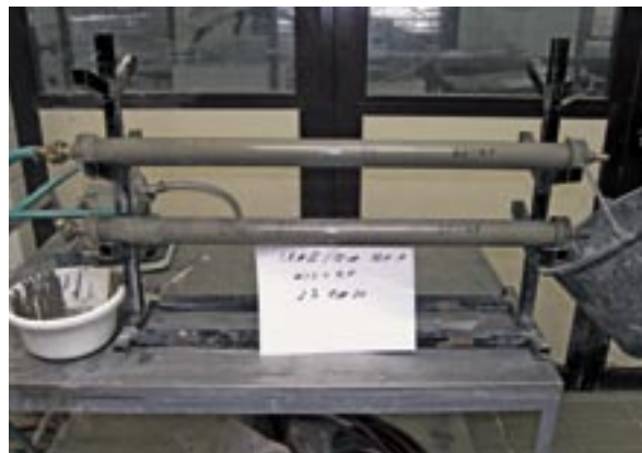
Bild 9: Versuchsdurchführung zum Injektionsverhalten des Zements CEM II/B-M (S-LL) 32,5 R-AZ mit 2 % ACE 30
