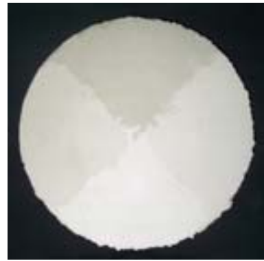
Bild 12: Eigenfarben der Zemente (oben: CEM I 32,5 R, rechts: CEM II/B-M (S-LL) 32,5 R-AZ, unten: CEM III/A 32,5 N-LH/NA, links: CEM II/B-S 32,5 R)
