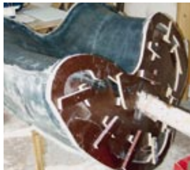
Bild 4: Schalungsform aus Glasfaserkunststoff
