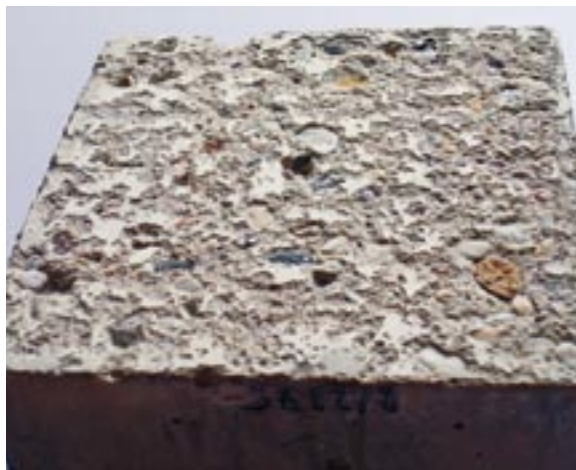
Bild 5: Abgewitterte Prüflfläche (CDF-Verfahren)
