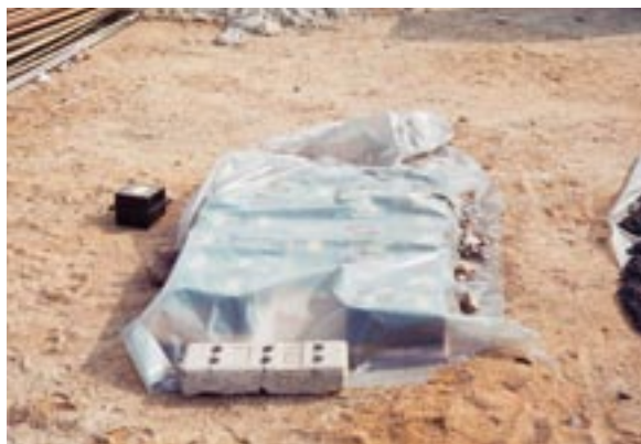
Bild 7: Lagerung von Prüfkörpern auf der Baustelle
