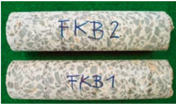
Bild 12: Bohrkern ( \varnothing = 10 \text{ cm} , L = 36 \text{ cm} ) aus der Start- und Landebahn
