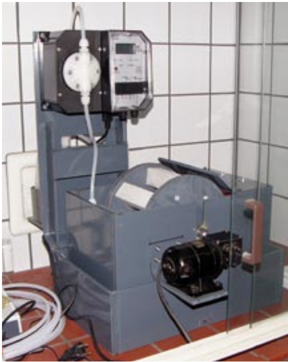
Bild 4: Neu entwickelter Säureprüfstand mit in den Prüfstand integrierter Bürste bei aufgeklappter Abdeckung
