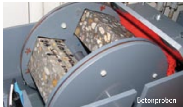
Bild 4: Neu entwickelter Säureprüfstand mit in den Prüfstand integrierter Bürste bei aufgeklappter Abdeckung
