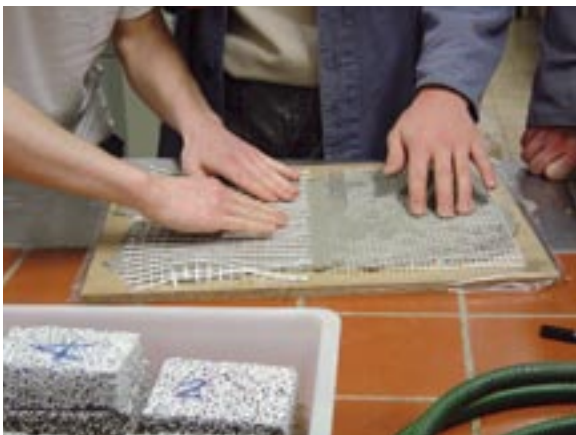
Bild 8: Herstellung der Versuchsplatten
