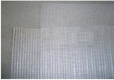
Bild 5: Bewehrungslagen aus alkaliresistenten Glasfasern
