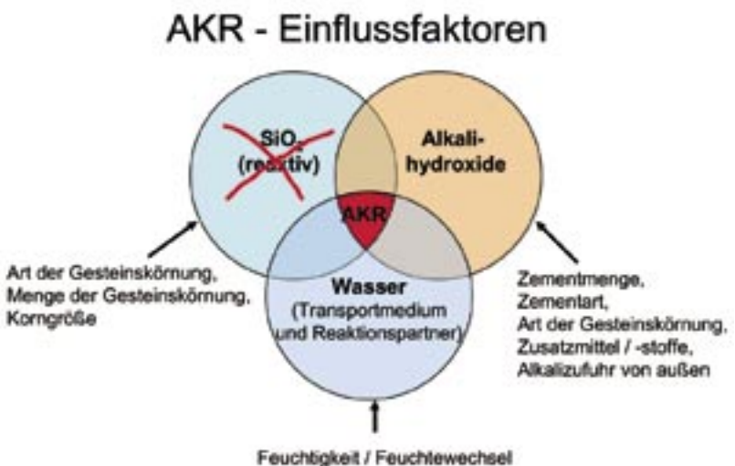
Bild 4: Voraussetzungen für eine schädigende Alkali-Kieselsäure-Reaktion: Nur wenn alle drei Einflussfaktoren gegeben sind, kann eine AKR stattfinden.
