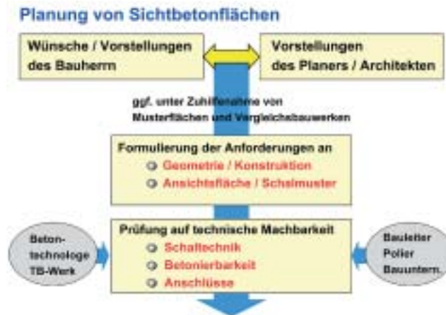
Bild 5: Planungsschema für Sichtbetonbauteile
