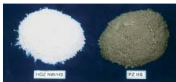
Bild 4: Farbunterschiede durch Verwendung unterschiedlicher Zementarten
