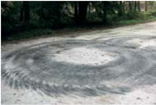
Bild 15: Drehversuch mit 60 t-Panzer als praktischer Nachweis der Abriebfestigkeit
