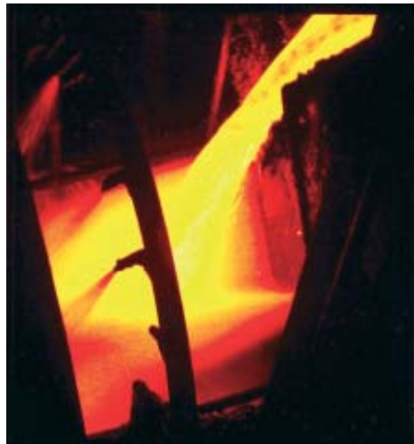
Bild 1: Spritzkopf in einer Granulationsanlage
