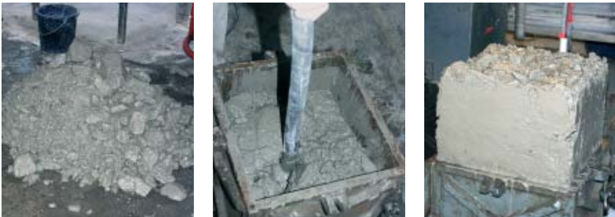
Bild 8: Kernbeton vor der Probekörperherstellung (links), während der Bestimmung (Mitte) und nach der Bestimmung des Verdichtungsmaßes (rechts)
