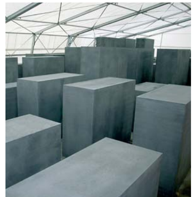
Bild 17: Lagerung der Betonstelen im temperierten Zwischenlager
