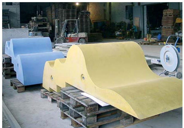
Bild 8: Ausgeschaltete „Betonwellen“ vor der Hydrophobierung
