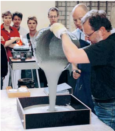
Bild 9: Ausfüllen von Silikonformen mit sehr fließfähigem „Beton“, ...
