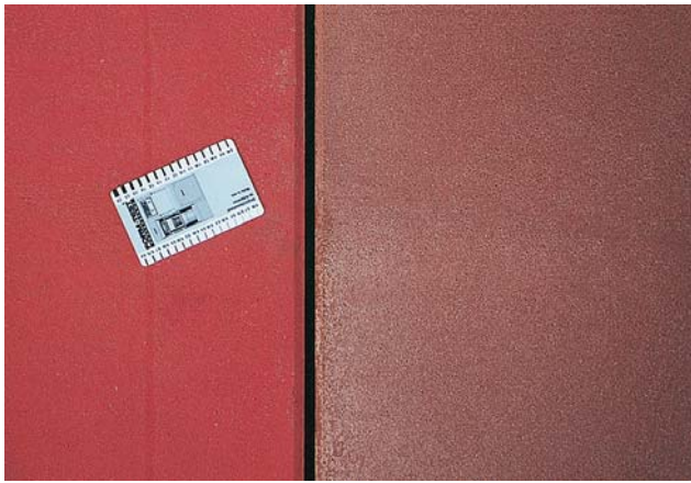
Bild 3: Farbvergleich an Gehwegplatten: links mit CEM III/A 42,5 N Optacolor®, rechts mit üblichem grauem CEM I (sonst gleiche Betonzusammensetzung und Pigmentzugabe)
