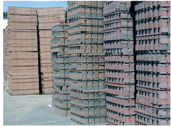
Bild 2: Vergleich der Farbbrillanz von Pflastersteinen gleicher Betonzusammensetzung: die vier vorderen Stapel rechts: Betonwarenzement CEM III/A 52,5 N; hinterer Stapel links: CEM I 42,5 R
