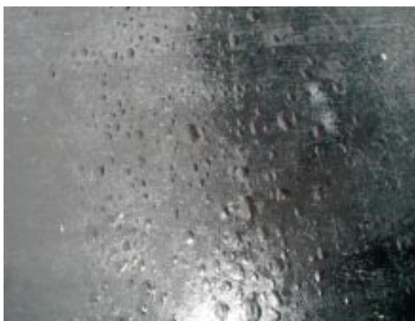
Bild 9: Blasen in dem Phenolharzfilm der Schaltafel
