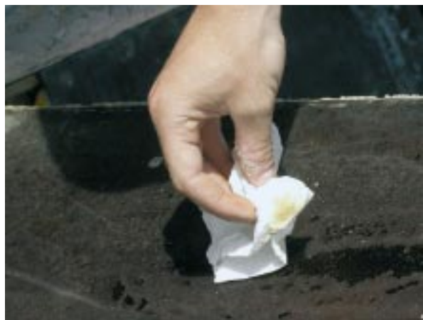
Bild 10: Wischprobe an gebrauchter Schalung Fabrikat C
