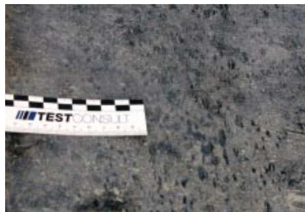
Bild 5: Blasen in der Schalhaut nach Baustelleneinsatz
